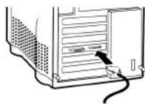
Conectando o cabo SCSI à placa de áudio (sistema Pro Tools Project)
