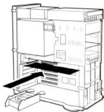
Instalando a placa de áudio do Pro Tools Project
